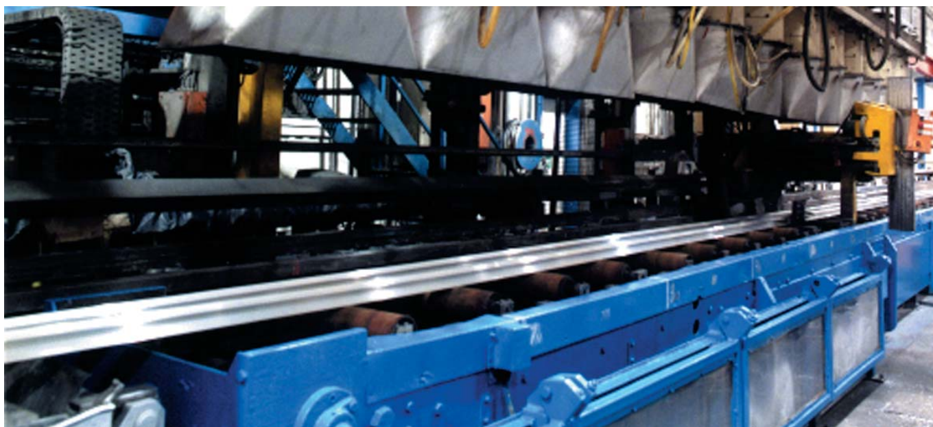
Típico sistema de enfriamiento por aire en una extrusión de aluminio
